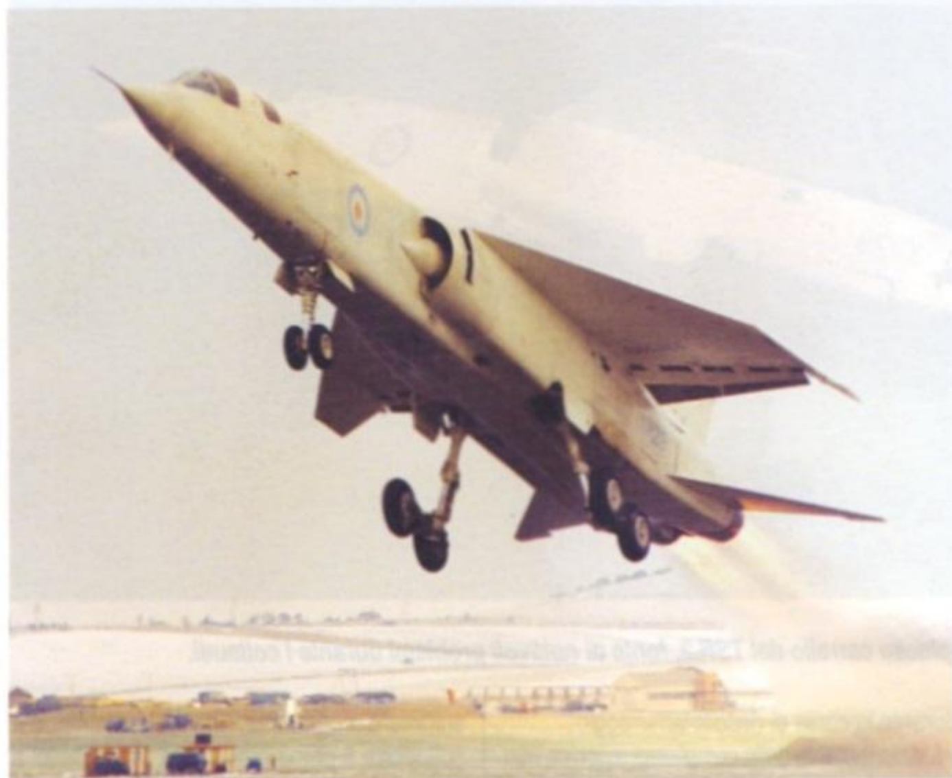
Decollo ripido in piena postcombustione dell'unico TSR.2 collaudato in volo (matricola XR219).
