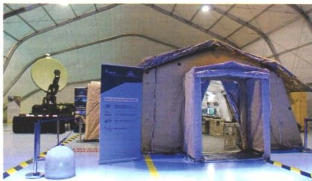
A sinistra: il data link a banda larga (Wide Band Data Link, WBDL). Sopra: una vista d'insieme del WBDL e della tenda pneumatica che costituisce la sede della Transportable General Ground Station (TGGS). (foto: Autore)
