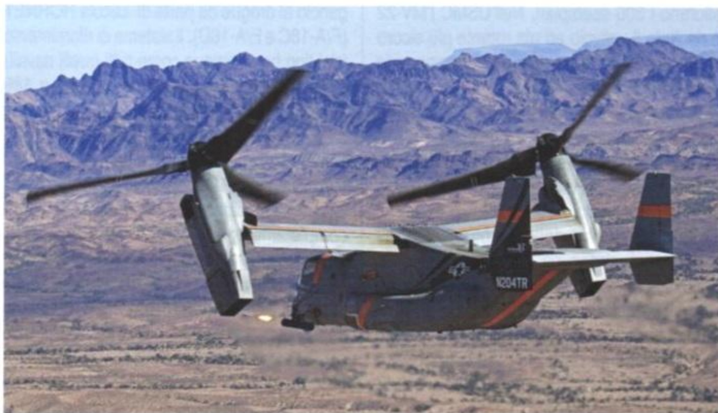
Un'immagine delle prove di lancio di razzi guidati effettuate nell'ambito dei programmi di potenziamento dell'armamento dell'OSPREY. (foto: NAVAIR)
