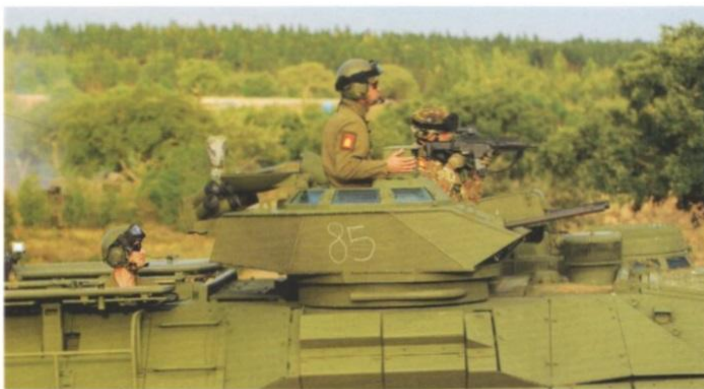
Un particolare della torretta di un AAV-7 dei Lagunari. Il veicolo è dotato di una torre armata di mitragliatrice da 12,7 mm più un lanciagranate automatico da 40 mm ad azionamento elettrico. (foto: NATO)
