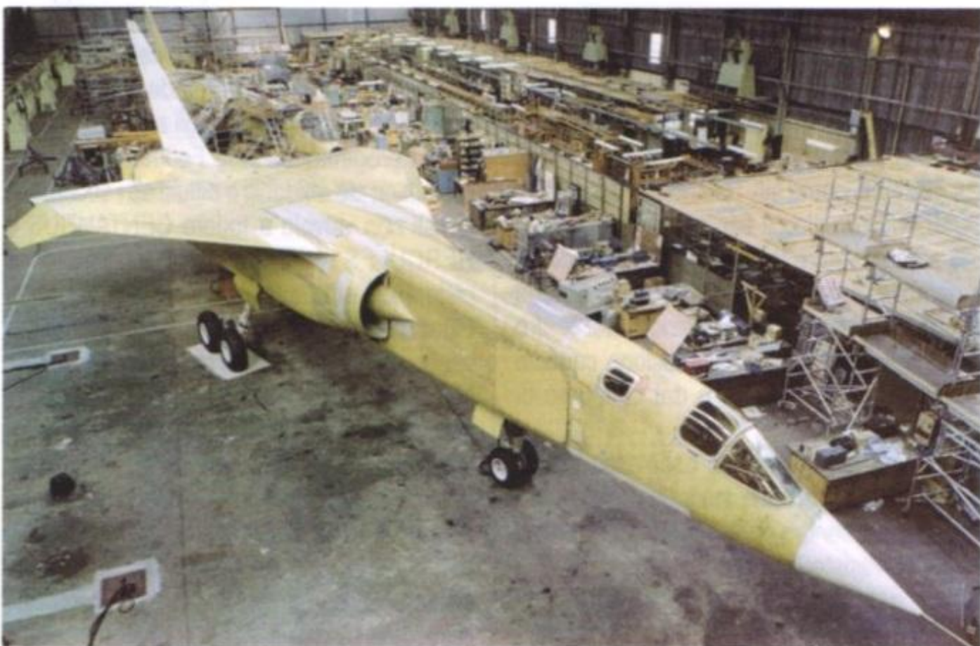
Il prototipo matricola XR219 in costruzione a Warton. Gran parte della cellula era realizzata in titanio, per tollerare le elevate temperature del volo a Mach 2,2.
