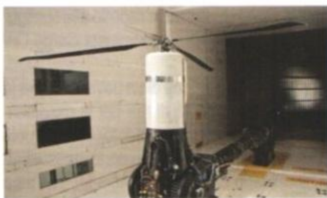
Una foto dei test sulle nuove pale avanzate denominate ACRB (Advanced CHINOOK Rotor Blade), destinate alle evoluzioni del CH-47F (e facilmente retrofittabili su tutte le macchine di questo modello). Il sito Boeing di Ridley Park dispone di una grande galleria del vento, la seconda degli Stati Uniti. (foto: Boeing)
