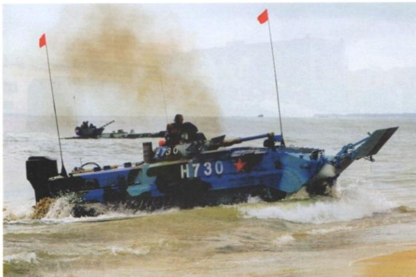
Il Type 86B cinese è ottenuto per (estesa) modifica del veicolo da combattimento per la fanteria russo della famiglia BMP-1. Notare il motore fuoribordo montato nella parte posteriore del veicolo.
