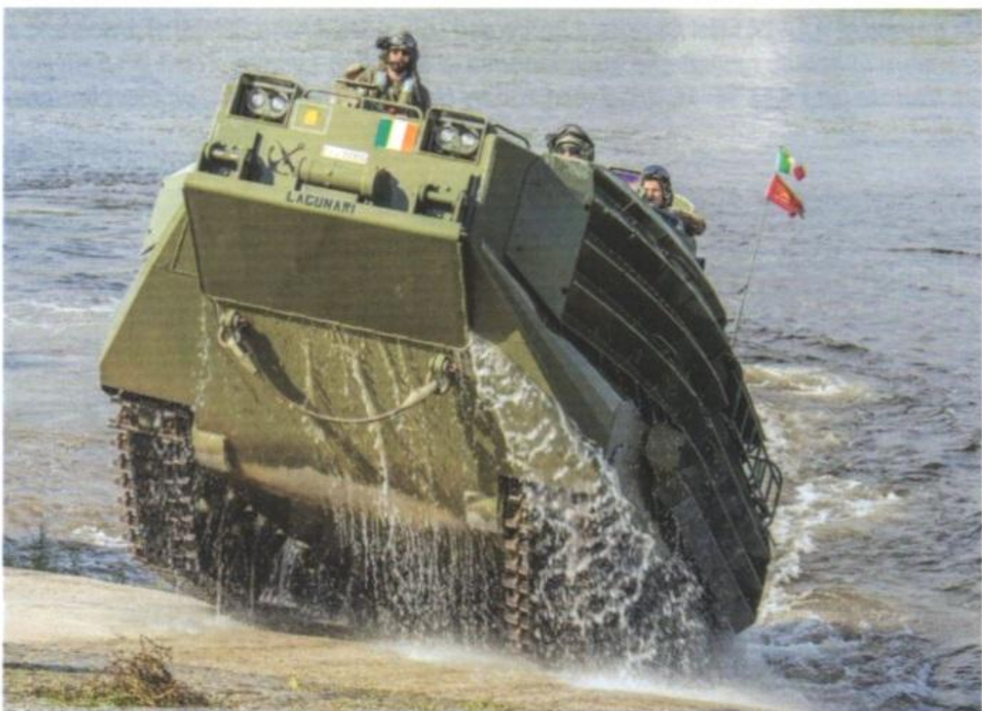
Un'altra immagine della presa di terra di un AAV-7 del Reggimento Lagunari SERENISSIMA dell'EI. I veicoli sono stati tutti da tempo portati allo standard RAM/RS a cura delle Officine Goriziane. (foto: NATO)
