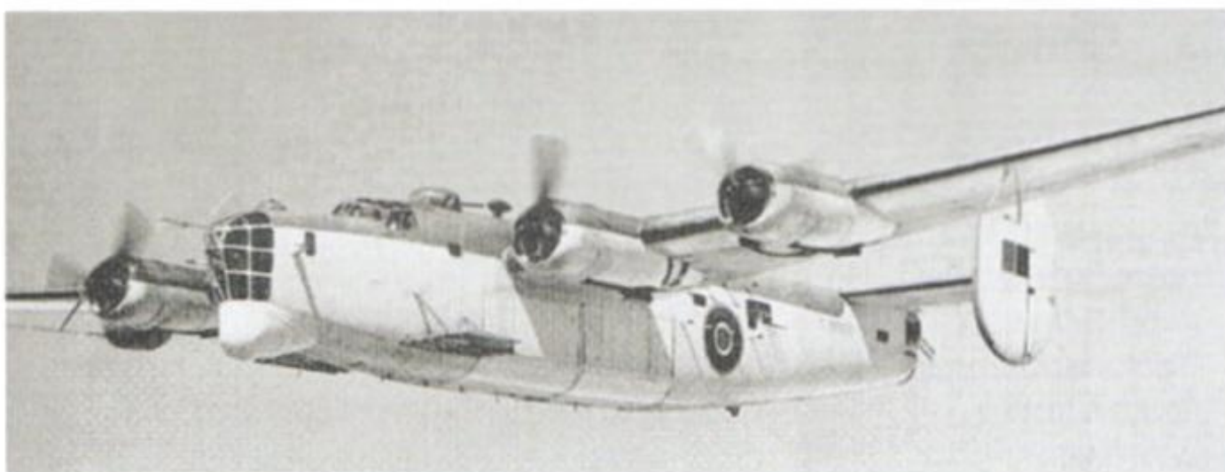
Un LIBERATOR GR V della RAF equipaggiato con radar ASV Mk-III installato nel radome e guide per razzi.
