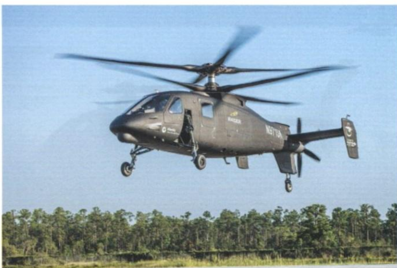
Una foto del primo volo dell'elicottero compound S-97 RAIDER. Tale macchina, realizzata da Sikorsky, rappresenta un po' il "fratello minore" dell'SB-1 DEFiant. (foto: Boeing)
