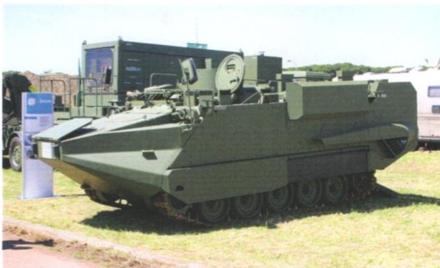
L'ARISGATOR, realizzato dalla Aris di Lombardore (TO) per modifica dell'M-113, è in servizio nella MM (SAN MARCO) in una trentina di esemplari. (foto: Eugenio Po)
