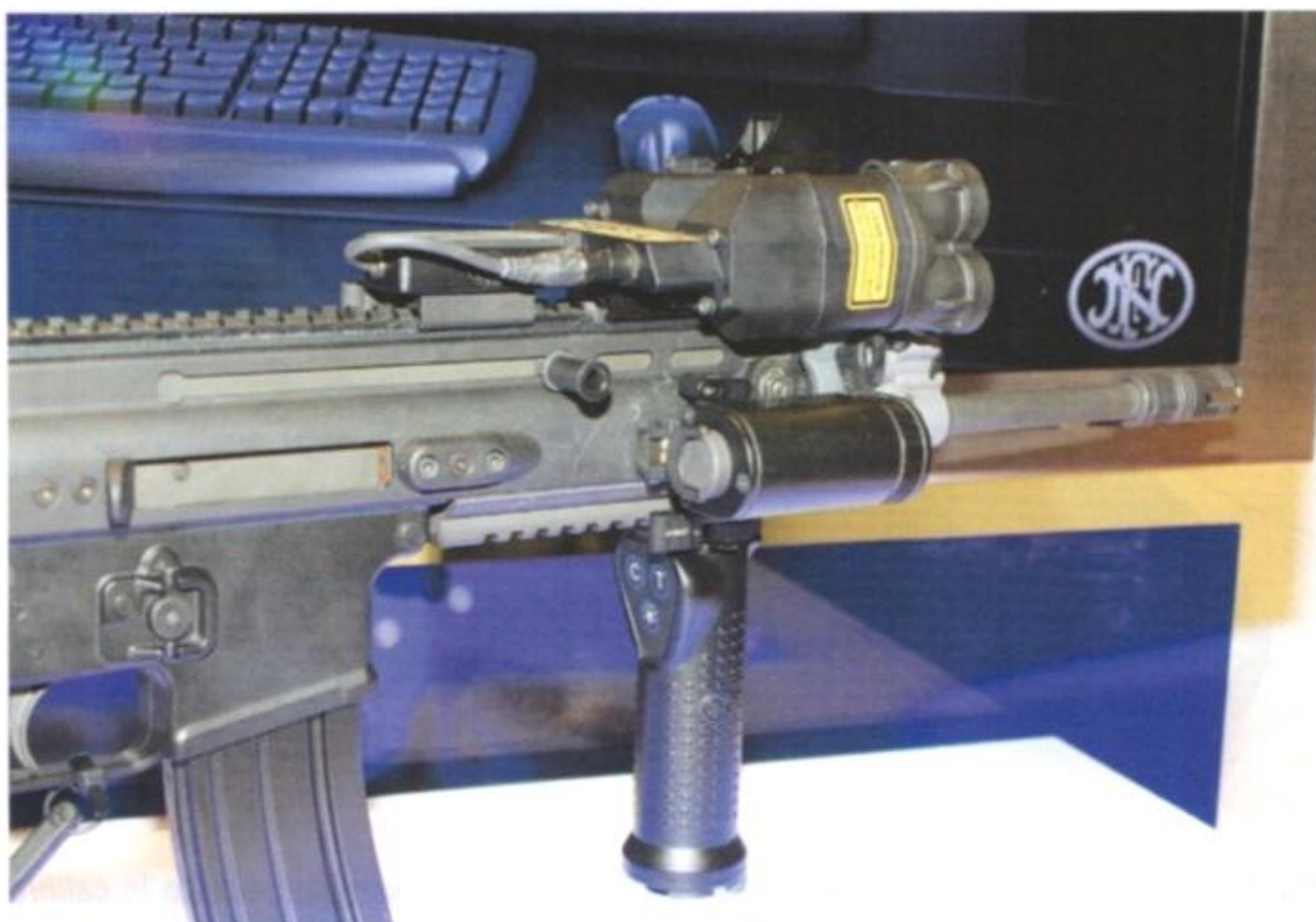
Il nuovo TASAAM della FN Herstal, montato su un fucile SCAR L 5,56 mm della stessa FN: un sistema di comando e controllo e di condivisione della consapevolezza tattica.
