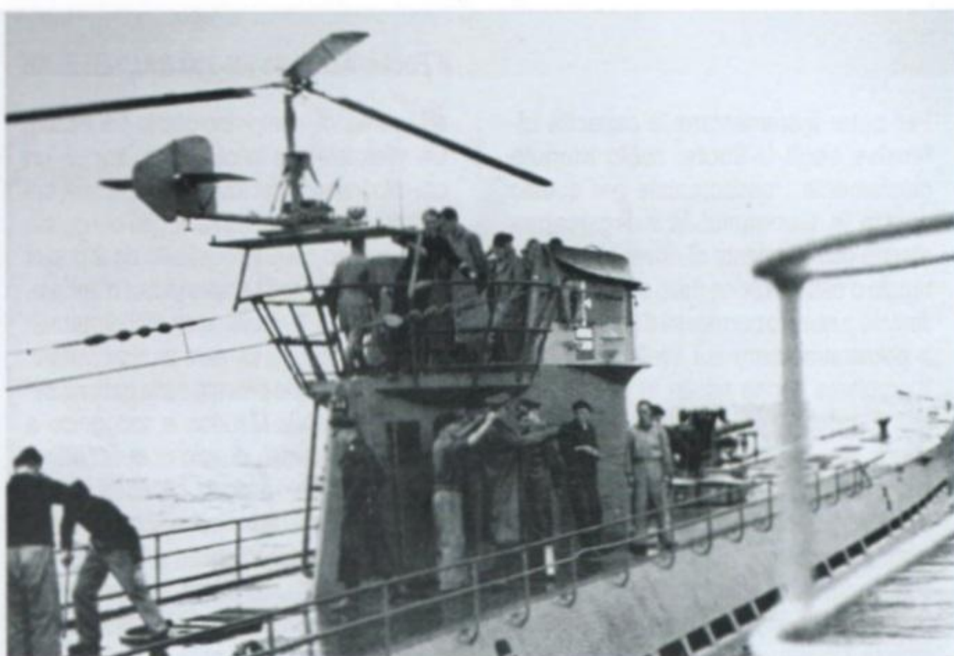
Sopra: un battello Tipo IX D/2 con l'FA-330 BACHSTELZE montato e pronto ad innalzarsi. Sotto: l'imponente falsatorre dell'U-861, Tipo IX D/2, al comando del KK Jürgen Östen.
