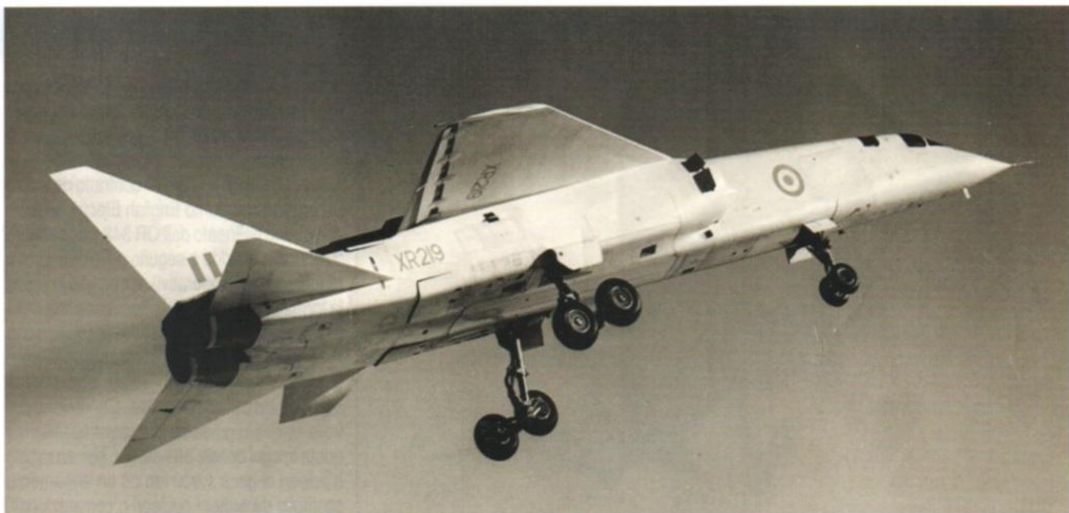
Una foto che evidenzia il complesso carrello del TSR.2, fonte di notevoli problemi durante i collaudi.
