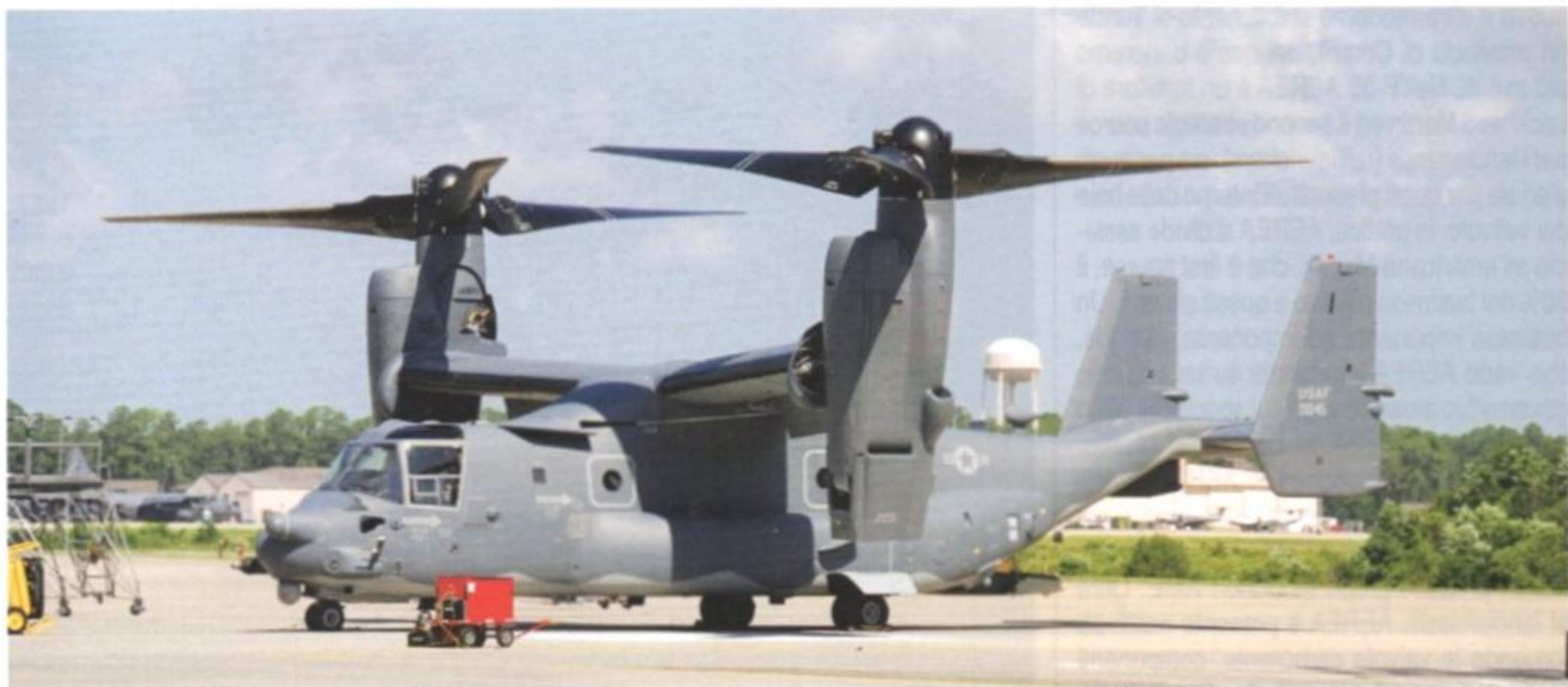
Un convertiplano CV-22 del 1 st Special Operation Wing dell'USAF fotografato ad Hurlburt Field, in Florida. L'OSPREY viene realizzato da Boeing insieme a Bell, nell'ambito di una collaborazione paritetica. (foto: Autore)
