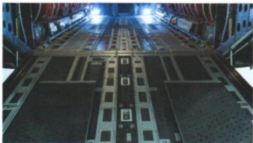
Il nuovo pavimento del vano di trasporto del CHINOOK è facilmente riconfigurabile da passeggeri a cargo. (foto: Boeing)
