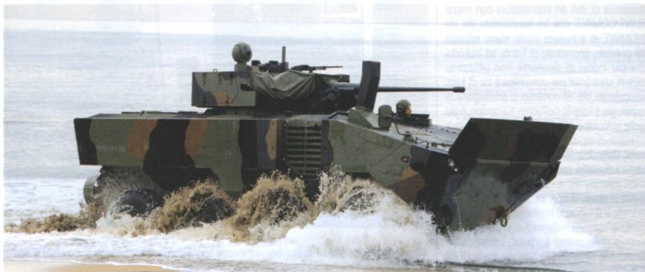
Uno dei prototipi del VBA, Veicolo Blindato Anfibo, costituito dal SUPERAV dotato di torretta ORWS armata di mitragliera da 30 mm, nel corso di una dimostrazione delle sue capacità sulla spiaggia di Nettuno. (foto: Eugenio Po)
