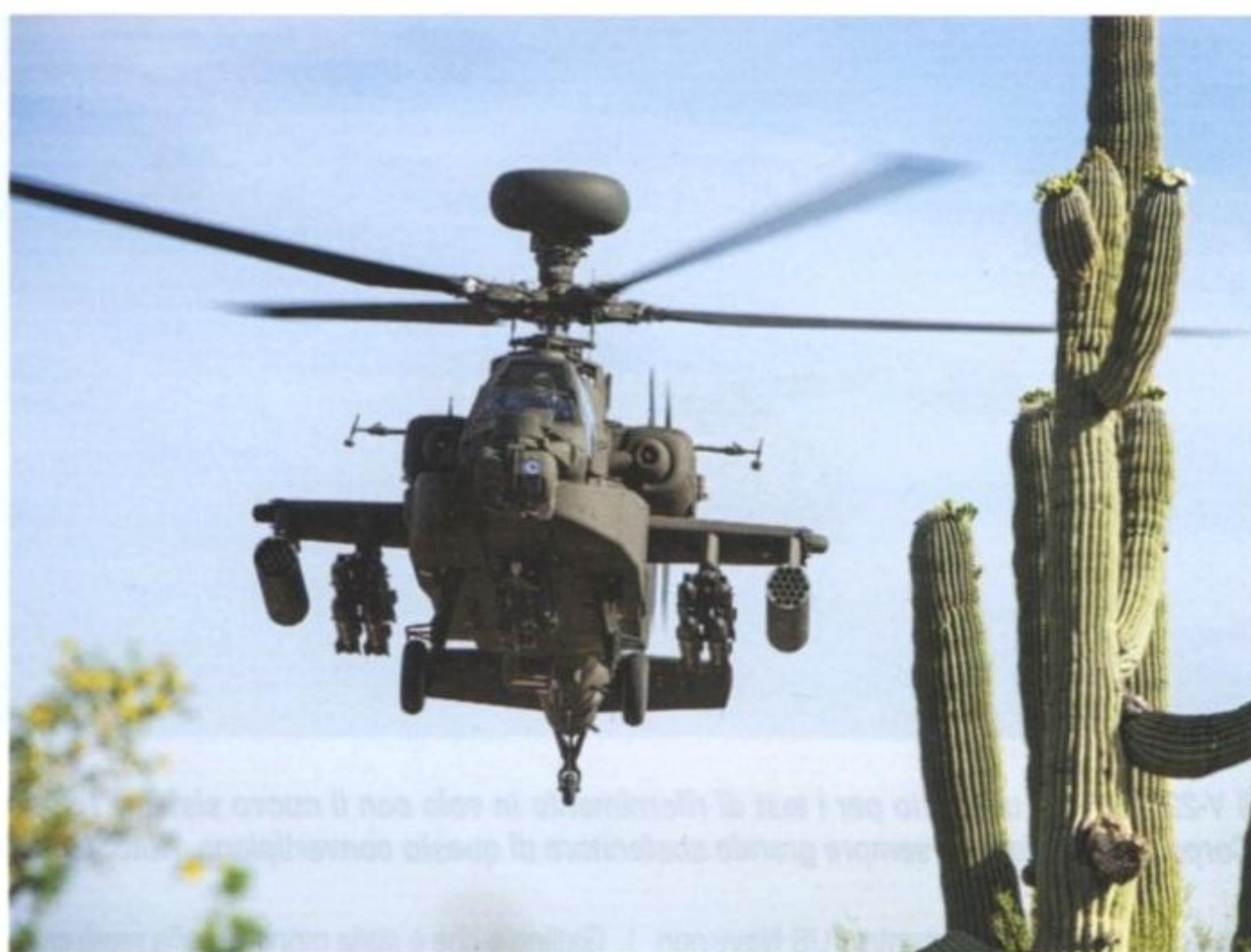
Anche il nuovo elicottero d'attacco AH-64E GUARDIAN, come il CH-47F, è il frutto di un radicale programma di aggiornamento del precedente modello D. (foto: Boeing)
